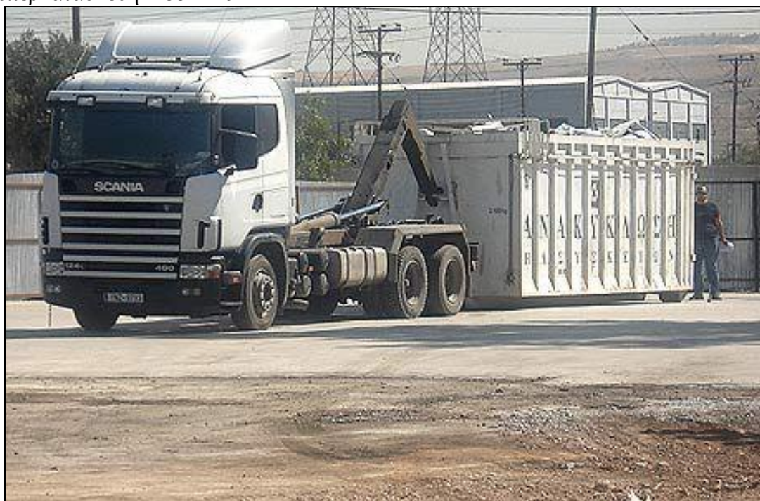
Εικόνα 18: Όχημα μεταφοράς κάδων τύπου ‘roll – open top container’ με υπερκατασκευή ‘hook-lift’
